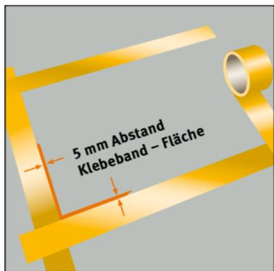
Grundierungen und Primer sind so aufzutragen, dass die grundierte Fläche über die später abgedichtete Fläche ca. 5-10 mm hinausragt.
