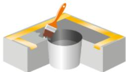
Die erste Schicht Flüssigkunststoff BauderLIQUITEC PU wird großzügig und gleichmäßig aufgetragen (ca. 2/3 der angegebenen Verbrauchsmenge). Unbedingt darauf achten, dass kein Flüssigkunststoff in den Ablauf gelangt.
