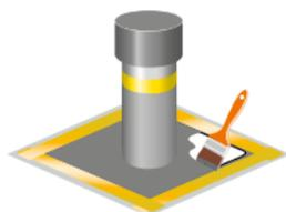
Direkt im Anschluss wird die Deckschicht nass-in-nass auf dem Vlies verteilt (restliches 1/3 der angegebenen Verbrauchsmenge).
