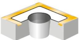
Zuschnitt 2 in die Flüssigkunststoffschicht falten- und hohlraumfrei einlegen und leicht andrücken.
