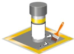
Auftretende Überlappungen müssen zwischen den Vliesschichten zusätzlich mit BauderLIQUITEC PU eingestrichen werden, so dass keine Vliesschichten ohne eine dazwischenliegende Flüssigkunststoffschicht aufeinander liegen.
