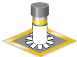
Vlieszuschnitt 1 umgehend in die noch feuchte erste Schicht BauderLIQUITEC PU falten- und hohlraumfrei einlegen und leicht aufdrücken.
