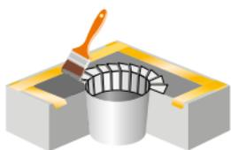
Die Zuschnitte überlappen dabei seitlich jeweils um ca. 1 cm. Diese Überlappungen müssen zwischen den Vliesschichten zusätzlich mit BauderLIQUITEC PU eingestrichen werden, so dass keine Vliesschichten ohne eine dazwischenliegende Flüssigkunststoffschicht aufeinander liegen.
